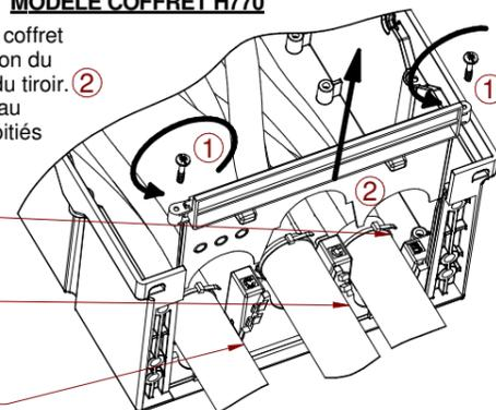
**ATTENTION :** Pour faciliter la mise en oeuvre des câbles et des unités fonctionnelles, **respecter** l'implantation suivante au niveau du dispositif de bridage.
