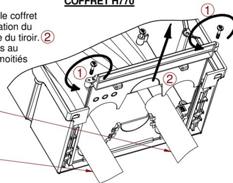
**ATTENTION :** Pour faciliter la mise en oeuvre des câbles et des unités fonctionnelles, respecter l'implantation suivante au niveau du dispositif de bridage.
